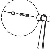
1 Postavite stranicu na kadu i obilježite poziciju. Pazite da prilikom obilježavanja ne oštetite stranicu. Prilikom postavljanja zidnog profila obavezno koristite libelu. Označite na profilu rupe gdje ćete bušiti. Maknite tuš stranicu i izbušite rupe u zidu koristeći 6,5 mm svrdlo. Stavite tiple u rupe.
