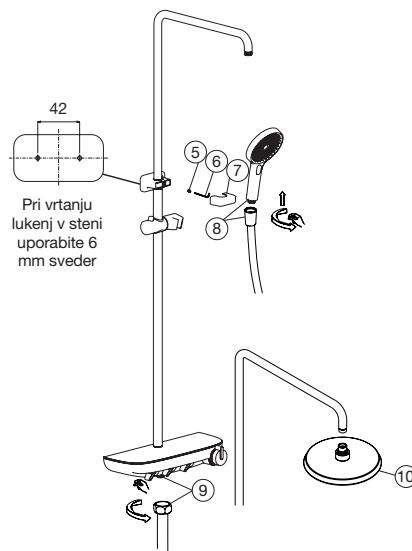
Po namestitvi izlivne cevi in nadglavne prhe na dnu armature previdno namestite tuš cev (9). Pritrdite glavo za prho (8) na drugi konec cevi. **POZOR:** Pred namestitvijo cevi na armaturo vmes namestite gumijasto tesnilo, da preprečite puščanje. Pri montaži tuš glave je tudi gumijasto tesnilo.
