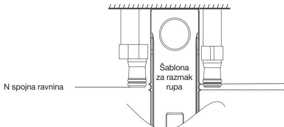
Šablonom za razmak rupa provjerite da li su spojnice postavljene u rasponu točaka stezanja.
