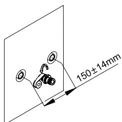
Pred montažo je treba spojke z notranjim navojem G1 / 20" namestiti vodoravno v steno z razmikom lukenj 150 mm (+/- 14 mm). Stenski priključek ne sme štrleti iz stene.
