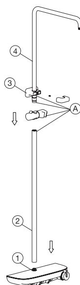
Postavite izlivno cev (2) na telo armature (1). Prepričajte se, da je izlivna cev navpična. Vstavite drsnik na izliv (2) in vstavite stenski nosilec (3) na vrh izlivne cevi (4), da ga pritrdite na steno. Z grafitnim svinčnikom označite mesto za vrtanje lukenj v steno. Prepričajte se, da so luknje ravne (preverite z vodno tehnicno).
