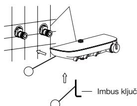
Po namestitvi armature na spojke se prepričajte, da se armatura s celim telesom oprime stene. Uporabite imbus ključ, da pritrdite masko armature na telo armature.
