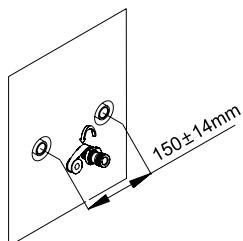
Prije montaže, spojnice G1/20" s unutarnjim navojem trebaju biti postavljene horizontalno u zidu sa razmakom rupa od 150mm (+/- 14mm). Zidni priključak ne smije viriti iz zida.
