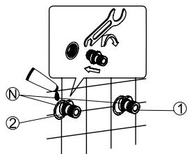
Očistite cijevi za dovod vode od pijeska i ostalih mogućih nečistoća. Na N točku spojnice namotajte malo teflon trake te spojnice postavite u zid.
