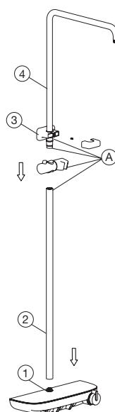
Postavite izljevnu cijev (2) na tijelo miješalice (1). Pripazite da izljevna cijev stoji okomit. Umetnute klizač na izljevnu cijev (2) te na gornji dio izljevne cijevi (4) umetnite zidni nosač (3) koji ćete učvrstiti na zid. Graftitnom olovkom označite poziciju za bušenje rupa u zidu. Pazite da su rupe u ravnini (provjerite libelom).
