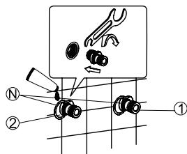
Očistite vodovodne cevi iz peska in drugih morebitnih nečistoč. Na točko N spojke navijte malo teflonskega traku in pritrdite spojko v steno. Z vodno tehtnico preverite, ali so spojke enako globoke.
